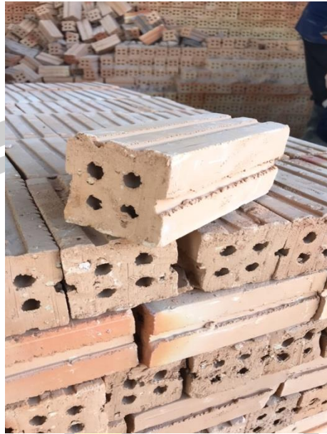
ภาพที่ 15 อิฐสีรุ้ง ขนาด 6.5x6.5x15 เซนติเมตร
