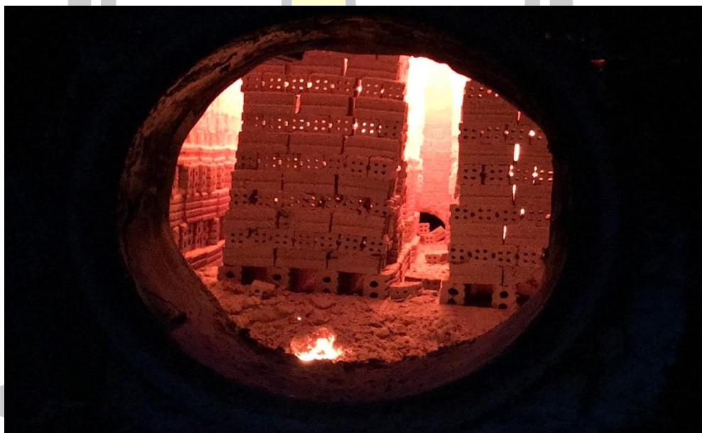
ภาพที่ 21 แสดงภาพอิฐที่เผาสุกแล้วภายในเตา
