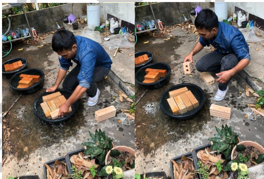
ภาพประกอบ ค 4.2 การนำอิฐแช่น้ำเป็นเวลา 24 ชั่วโมง
