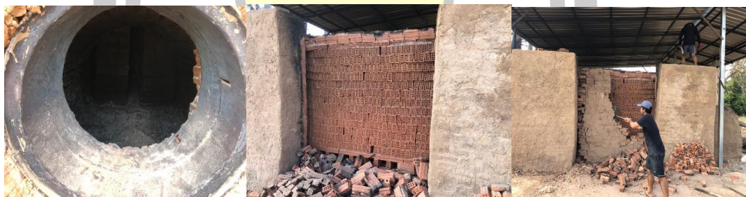
ภาพที่ 32 ลักษณะการสิ้นสุดกระบวนการเผาและเปิดเตา
