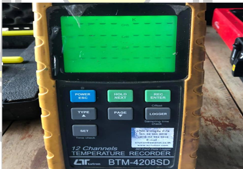
ภาพที่ 18 Data locker ยี่ห้อ Lutron รุ่น BMT-4208SD แบบ 12 channel
