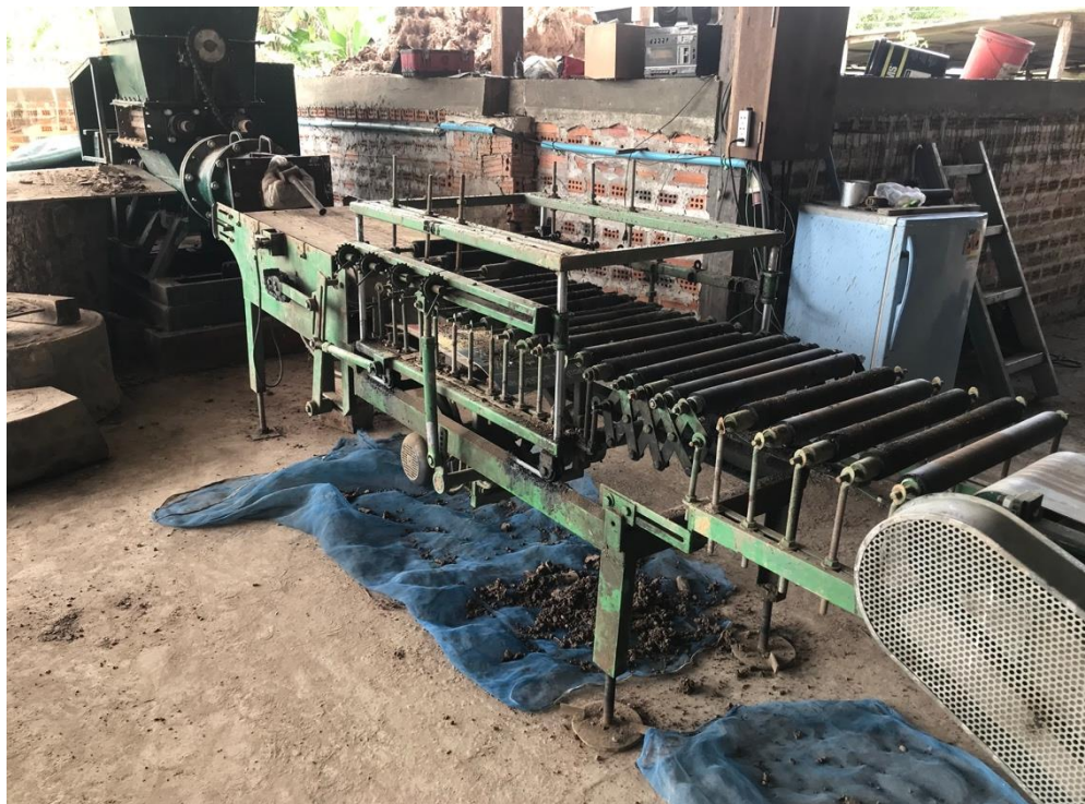
ภาพที่ 3 เครื่องตัดแบ่งก้อนอิฐอัตโนมัติสำหรับตัดเส้นดินให้เป็นก้อน
