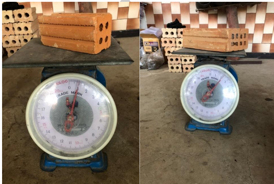
ภาพประกอบ ค 4.1 การชั่งน้ำหนักอิฐก่อนแช่น้ำ
