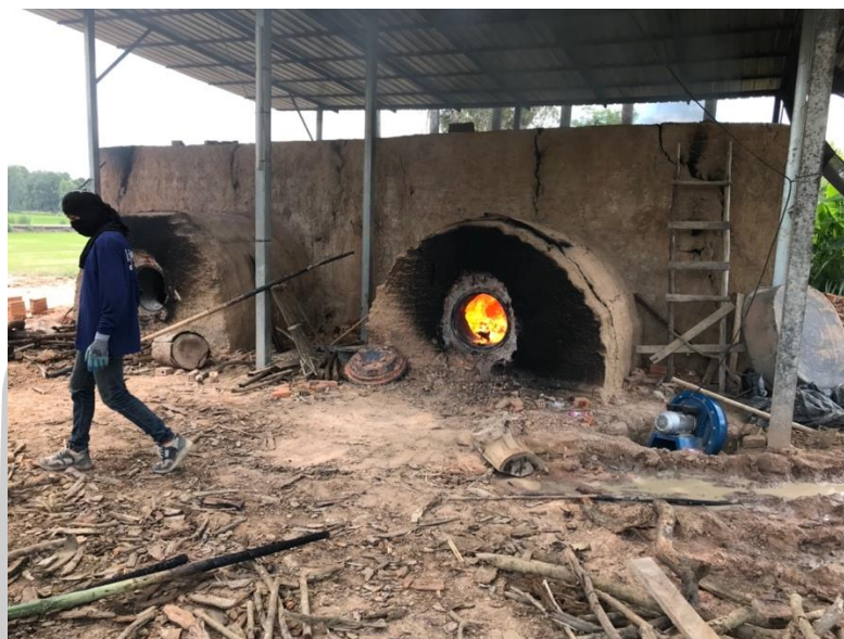
ภาพที่ 14 ภาพของเตาเผาอิฐแบบสี่เหลี่ยมชนิดความร้อนลง
