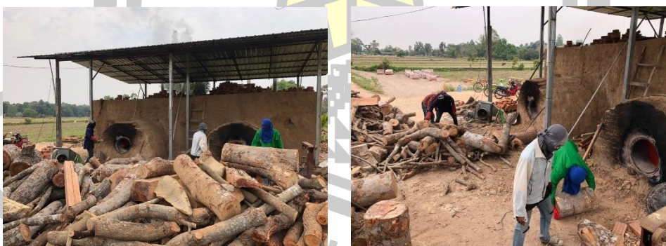
ภาพที่ 30 การทำงานในกระบวนการอุ่นอิฐ
