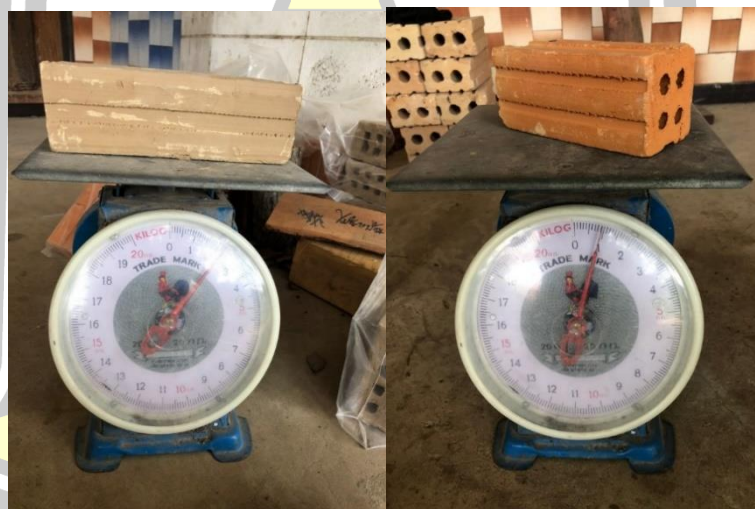
ภาพประกอบ ค 3.2 การชั่งน้ำหนักอิฐก่อนเผาและหลังเผา
