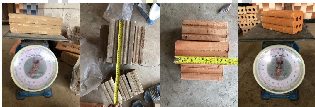
ภาพที่ 29 การวัดขนาดและชั่งน้ำหนักของอิฐมอญ
