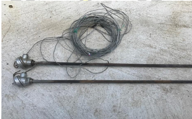
ภาพที่ 17 เทอโมคัปเปิล Type K ยี่ห้อ Interheat และสายสัญญาณ
