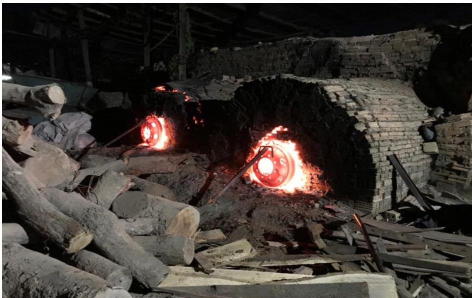
ภาพที่ 6 การเผาอิฐให้สุกด้วยเตาแบบสี่เหลี่ยมชนิดความร้อนลง
