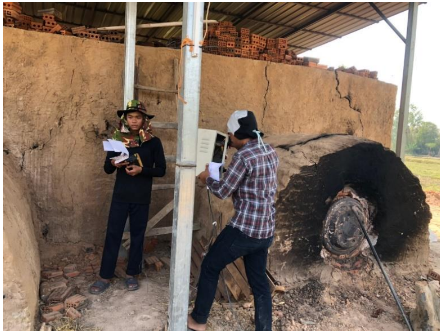
ภาพประกอบ ค.1.3 การวัดอุณหภูมิด้านหน้า
