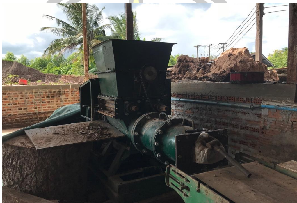
ภาพที่ 2 เครื่องรีดดิน (Extruder) สำหรับรีดดินเหนียวให้เป็นเส้น
