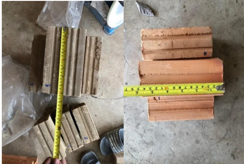
ภาพประกอบ ค 3.1 การวัดขนาดอิฐก่อนเผาและอิฐหลังเผา
