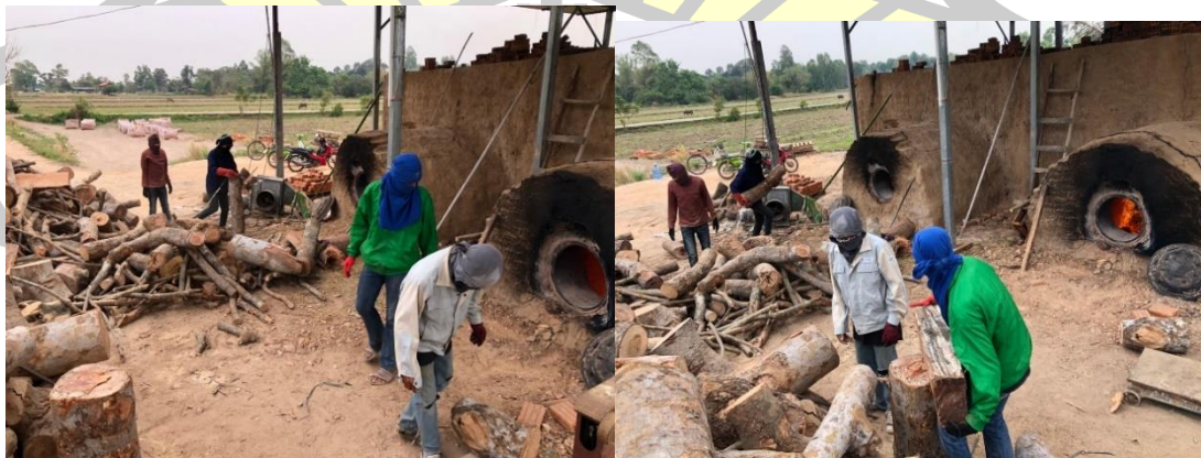
ภาพประกอบ ค 2.3 กระบวนการอบเพื่อไล่ความชื้นอิฐ
