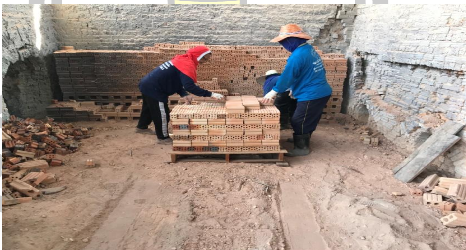
ภาพที่ 7 การเรียงอิฐสุกชนิด 4 รูใส่พาเลทเพื่อนำไปจำหน่าย
