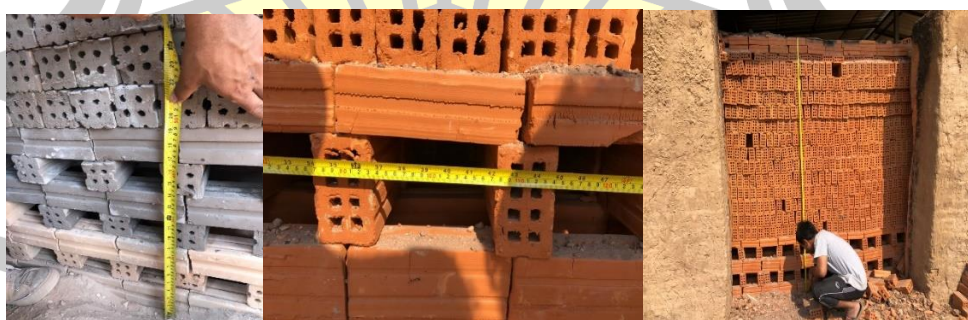
ภาพที่ 28 การจัดเรียงอิฐภายในเตาเผา
