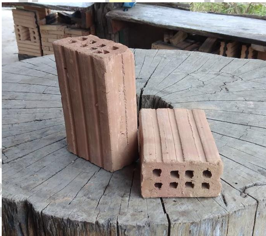
ภาพที่ 16 อิฐแปดรู ขนาด 12x6.5x20 เซนติเมตร
