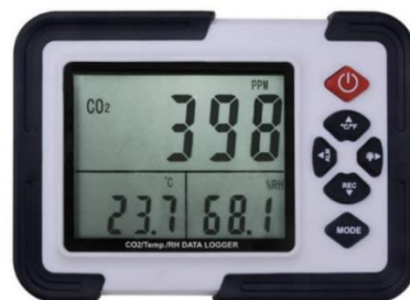
ภาพที่ 38 เครื่องมือวัดปริมาณแก๊สคาร์บอนไดออกไซด์ ( \text{CO}_2 )
