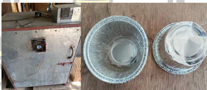
ภาพที่ 32 เครื่องอบแห้งแบบลมร้อน และภาชนะอลูมิเนียม
