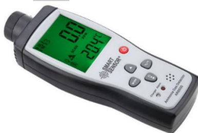
ภาพที่ 37 เครื่องมือวัดปริมาณแก๊สแอมโมเนีย ( \text{NH}_3 )
