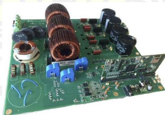
ภาพที่ 36 วงจรต้นแบบของวงจรเวียนนาที่พัฒนาโดย Texas Instruments
