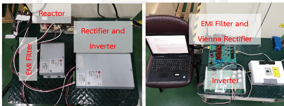
ภาพที่ 62 วงจรเรียงกระแสที่ใช้ในการทดสอบกับโหลดมอเตอร์ 1.3kW: (a) แบบ Passive, (b) แบบ Active PFC
