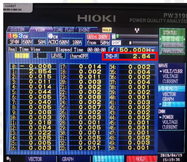
ภาพที่ 54 ทดสอบวัดความผิดเพี้ยนของฮาร์มอนิกรวมของกระแสไฟฟ้าด้านอินพุตที่โหลดตัวต้านทาน 1kW
