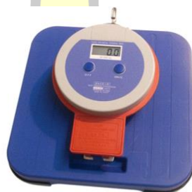
ภาพประกอบ 66 เครื่องวัดแรงเหยียดขา – หลัง (Back Legs Dynamometer)
