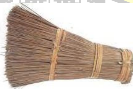
ภาพประกอบ 45 แปรงหวีหูกหรือแปรงหวีเครือเส้นด้ายยืน
