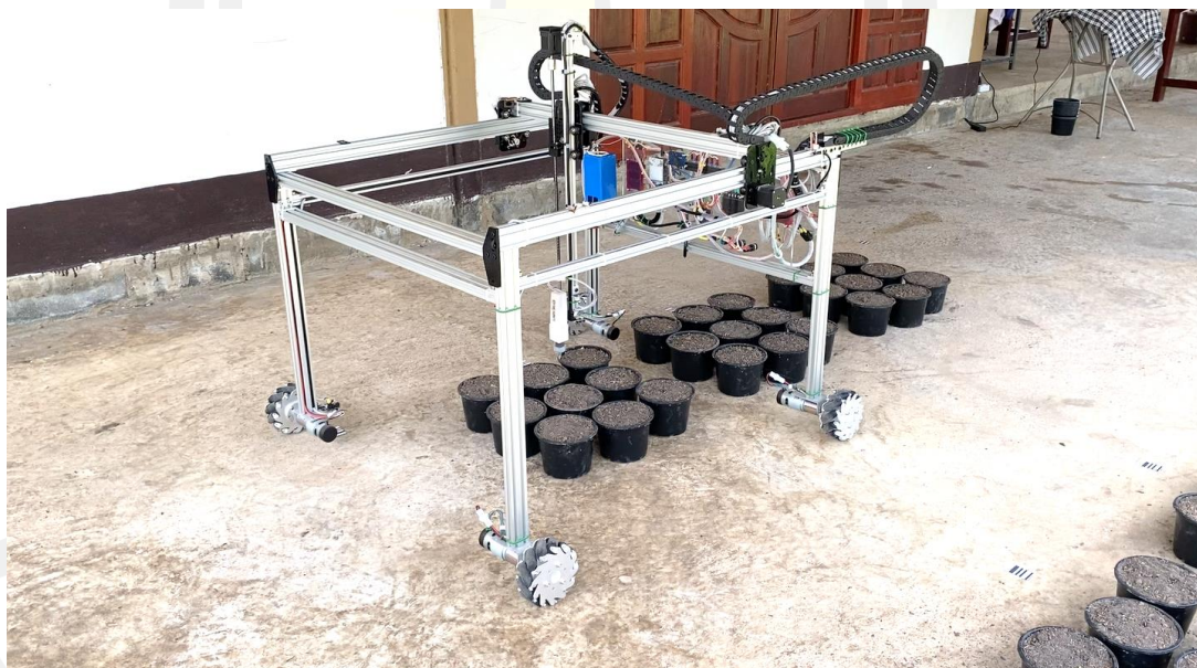
ภาพที่ 4.33 การทดสอบการหยอดเมล็ดของหุ่นยนต์ในแปลงปลูกจำลอง
