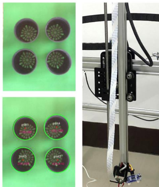
ภาพที่ 3.17 การทดสอบระบบการตรวจจับกระจ่างของหุ่นยนต์
