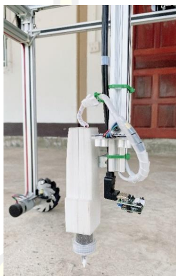
ภาพที่ 4.10 การติดตั้งชุด Sensors ของ Perception Part บนแกน z
