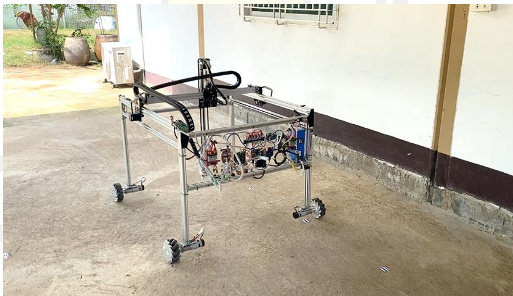
ภาพที่ 4.14 การทดสอบการทำงานของหุ่นยนต์ด้วยสัญลักษณ์ Barcode
