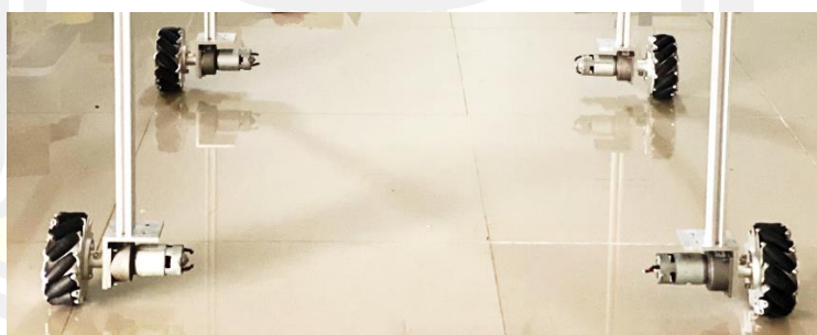
ภาพที่ 4.3 การติดตั้งชุดขับเคลื่อนเข้ากับเฟรมของหุ่นยนต์
