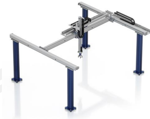
ภาพที่ 3.19 แนวคิดในการออกแบบโครงสร้างระบบการเคลื่อนที่ในระนาบ x-y ของหุ่นยนต์
