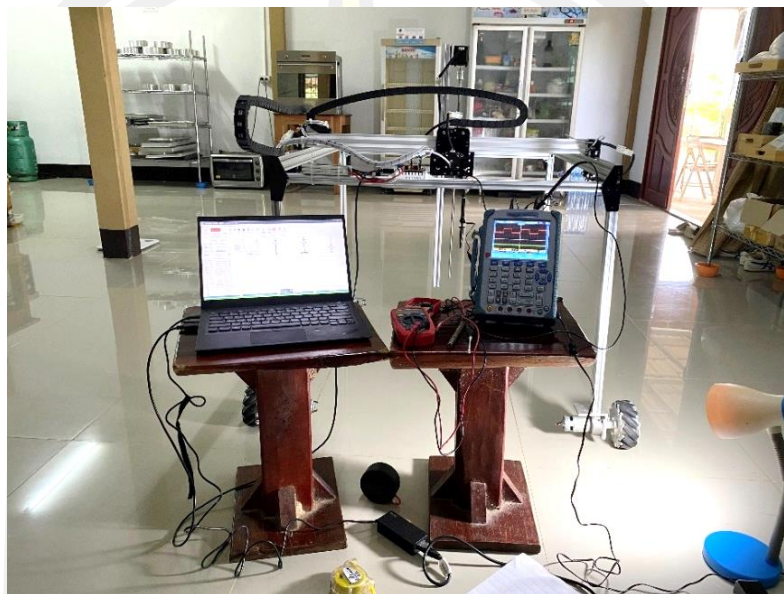
ภาพที่ 4.8 การทดสอบการเคลื่อนที่เชิงเส้นทั้ง 3 แกนของหุ่นยนต์
