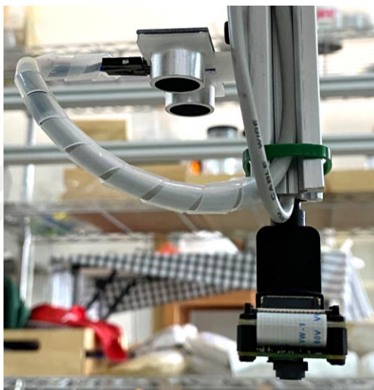
ภาพที่ 4.15 การติดตั้ง Ultrasonic distance sensor เพื่อใช้หาระยะของความสูง
