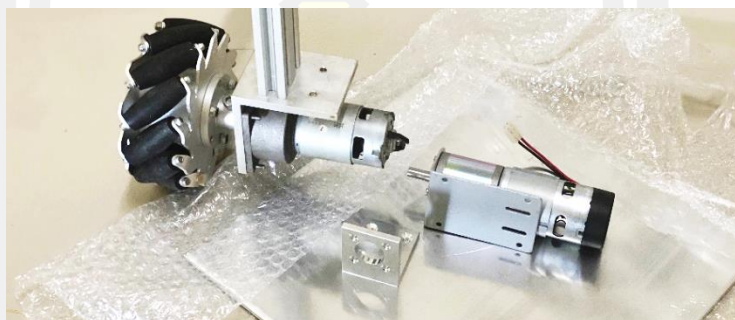
ภาพที่ 4.2 การติดตั้งเฟรมสำหรับยึดเกียร์มอเตอร์
