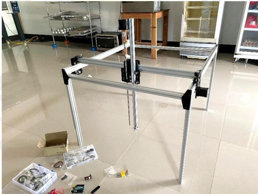
ภาพที่ 4.1 โครงสร้าง Aluminum Profile ของหุ่นยนต์
