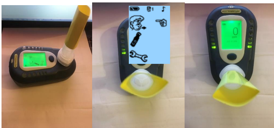
ภาพที่ 8 การใช้งานเครื่องวัดค่าคาร์บอนมอนอกไซด์ในลมหายใจออก Pico+ smokerlyzer
