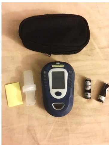
ภาพที่ 7 เครื่องวัดค่าคาร์บอนมอนอกไซด์ในลมหายใจออก Pico+ smokerlyzer
