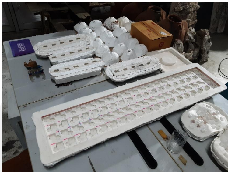
ภาพประกอบ 187 ขั้นตอนการทำพิมพ์รูปทรงข้างหมอบในการหล่อเรซิ่นใส ที่มาข้อมูล : ปรีชา นวลน้อม
