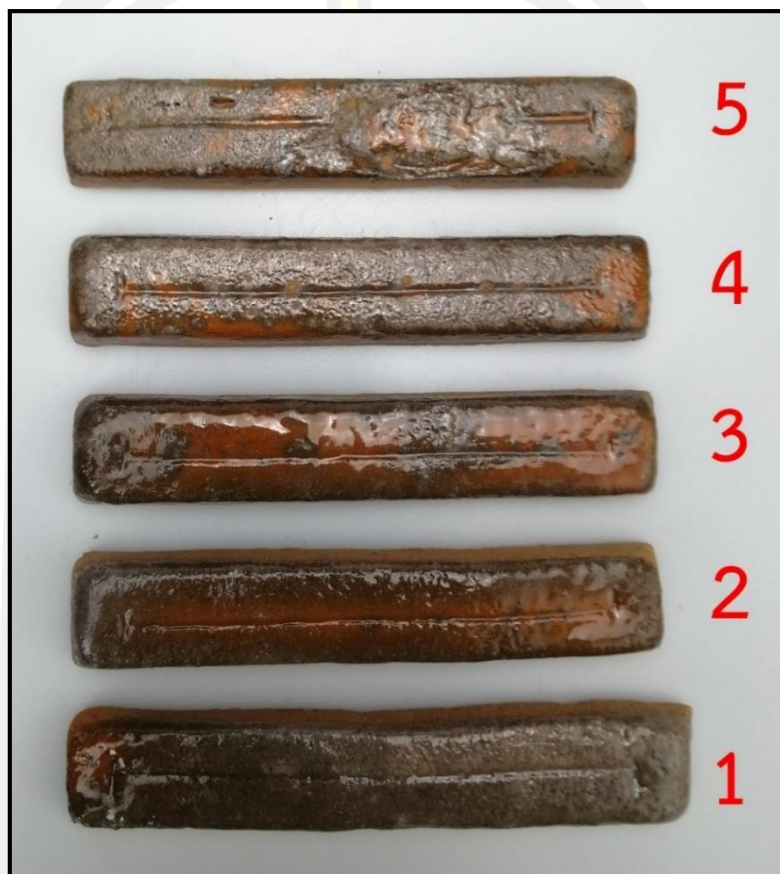
ภาพประกอบ 113 แท่งทดสอบเผาเคลือบ (ดินบ้านหม้อ+ทราย)
