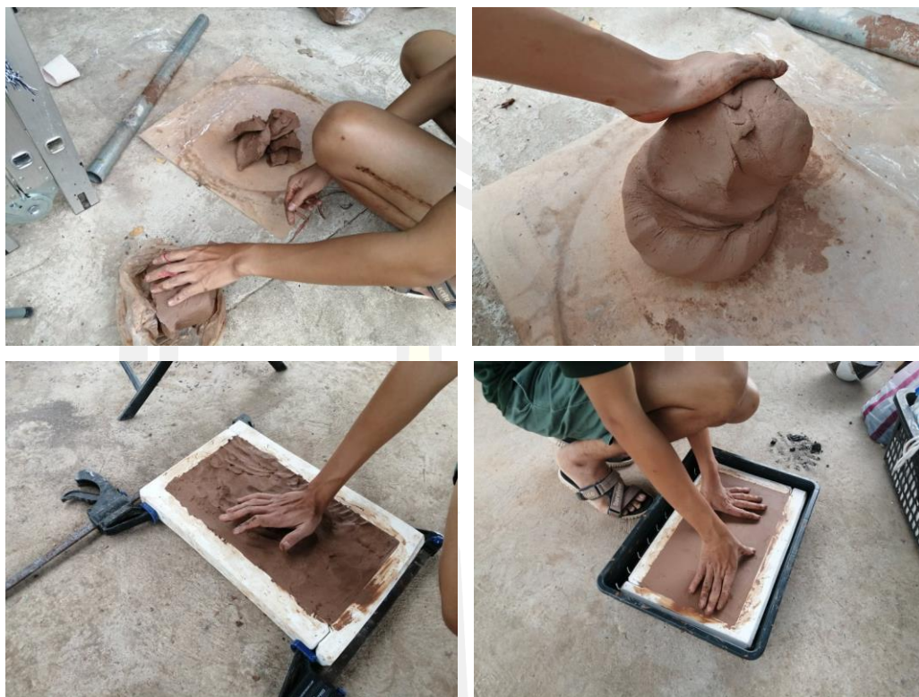
ภาพประกอบ 144 ขั้นตอนการอัดดินลงบนแม่พิมพ์
