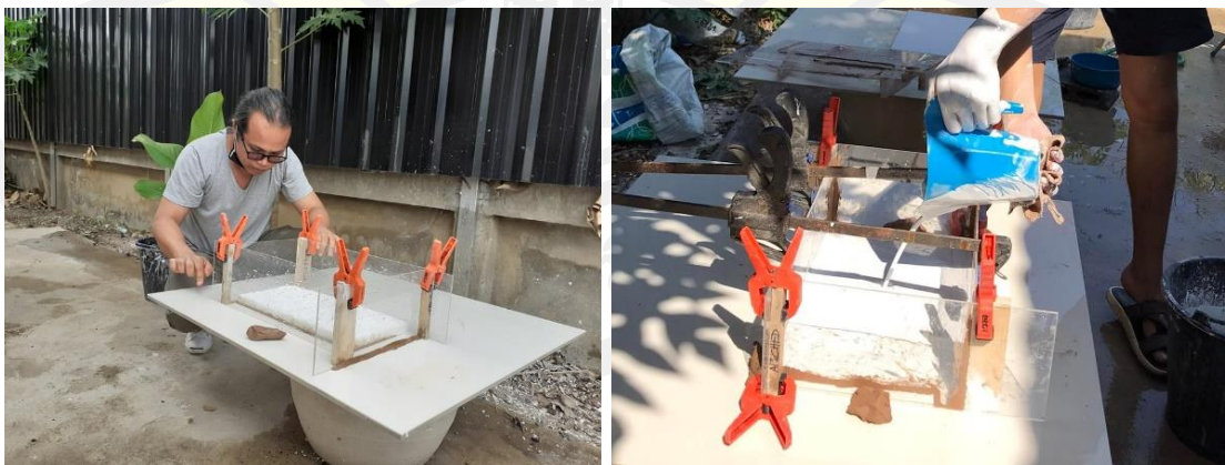
ภาพประกอบ 140 การหล่อแม่พิมพ์ปูนพลาสติก ภาพถ่ายโดย : วิชิตพงษ์ ตะราชี่
