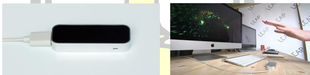
ภาพประกอบ 8 อุปกรณ์ Leap motion และการใช้งาน
