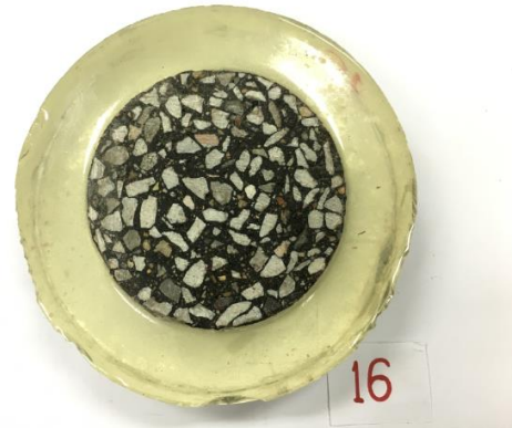
ภาพประกอบ ค15 ตัวอย่างทดสอบอัตราการซึมผ่านของน้ำ
