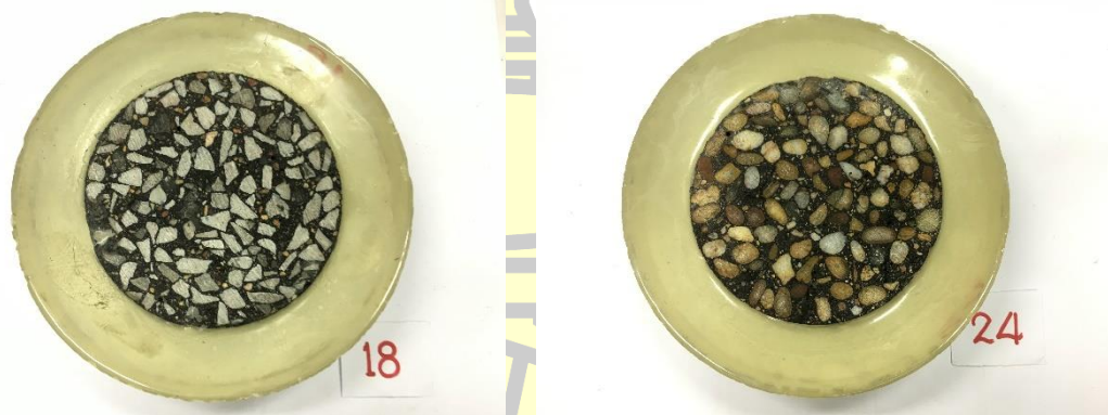
(ก) ตัวอย่างคอนกรีตที่ใช้หินปูนย่อยเป็นส่วนผสม
