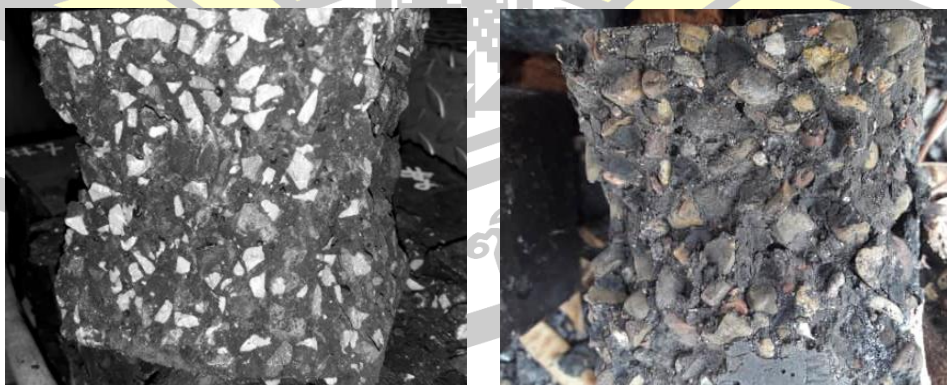
(ก) จีโอโพลิเมอร์คอนกรีตที่ผสมด้วยหินปูนย่อย (ข) จีโอโพลิเมอร์คอนกรีตที่ผสมด้วยกรวด
