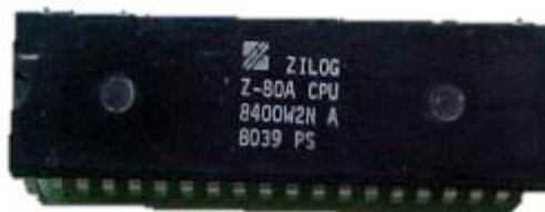
ภาพประกอบ 2.27 ไมโครคอนโทรลเลอร์ Z-80
