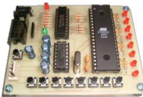
ภาพประกอบ 2.30 ตัวอย่างการต่อใช้งาน MCS-51 บนบอร์ดทดลอง
