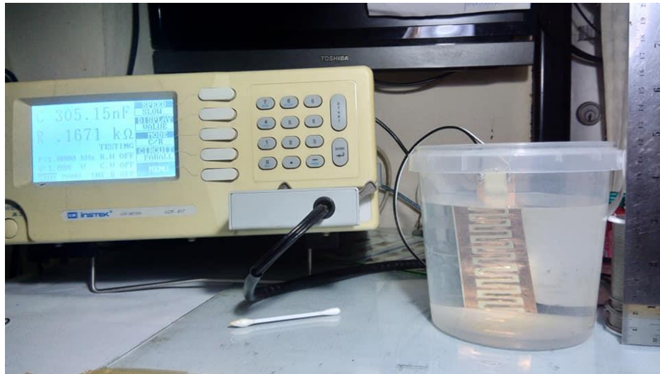
ภาพประกอบ 37 การวัดค่าการเก็บประจุของตัวรับรู่ระดับของเหลวแบบมีวัสดุฐานรอง
