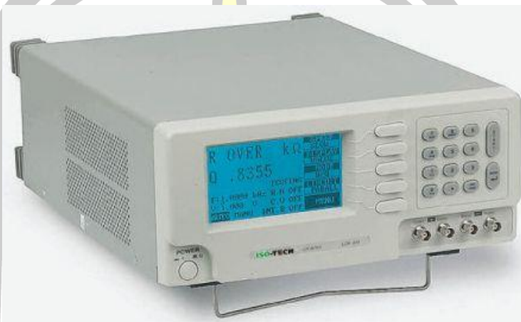
ภาพประกอบ 32 เครื่องวัดค่าการเหนี่ยวนำ ค่าการเก็บประจุ และค่าความต้าน (LCR Meter)
