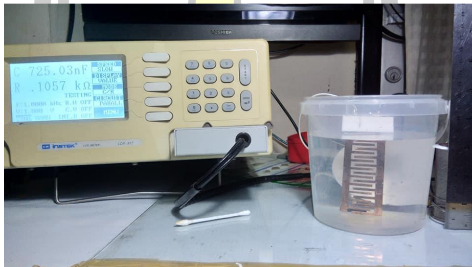
ภาพประกอบ 38 การวัดค่าการเก็บประจุของตัวรับรู่ระดับของเหลวแบบไร้วัสดุฐานรอง
