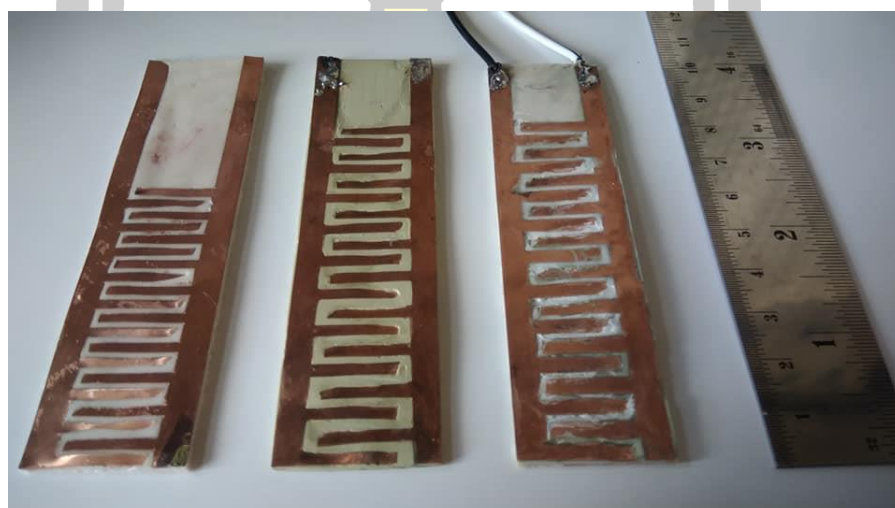
ภาพประกอบ 35 ตัวรับรู้ระดับของเหลวค่าการเก็บประจุอินเทอร์ดิจิทัลแบบมีฐานรอง (Epoxy)
