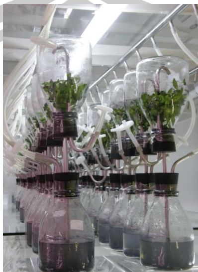
ภาพประกอบ 3 Temporary Immersion Gravity Flask Bioreactor – TIG [12]
