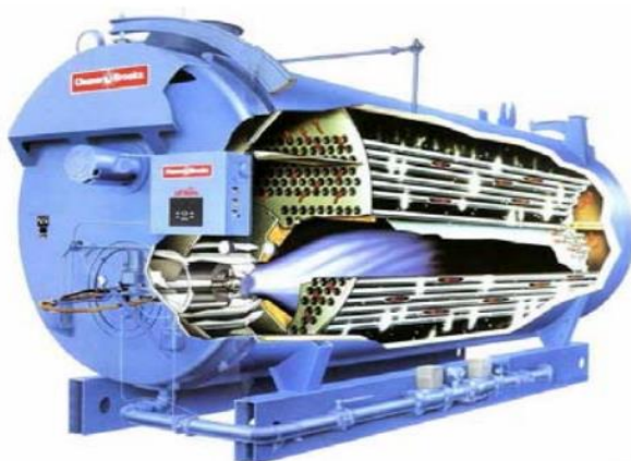
ภาพประกอบ 2.4 หม้อน้ำแบบท่อไฟ 4 กลีบ หลังแห้ง [1]
