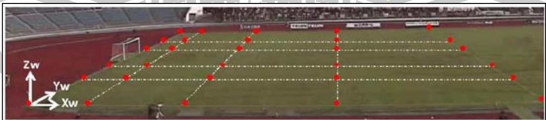
ภาพที่ 2.24 จุดสำหรับการสอบเทียบ (ที่มา: Nishino และคณะ [41])
