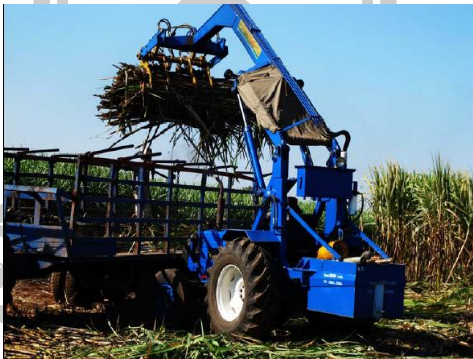
ภาพประกอบ 5 รถคีบอ้อยขึ้นรถบรรทุก
