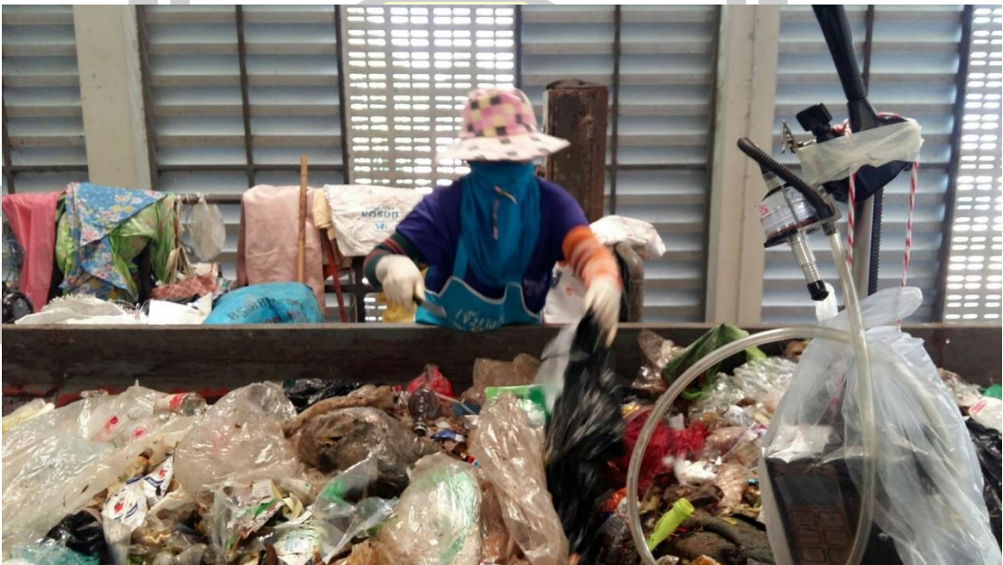
เครื่องเก็บตัวอย่างอากาศบริเวณสายพานคัดแยกมูลฝอย
