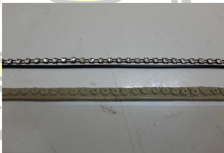
ภาพประกอบ 128 หลุมพลาสติกและสายไฟ ทดแทนวัสดุแบบดั้งเดิม
