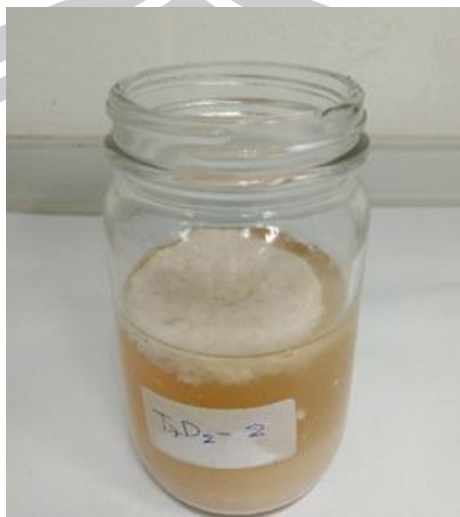
ภาพที่ 12 การตกตะกอนเอ็กซ์โพสิทีแซคคาไรด์ด้วยเอทานอล
