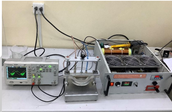
ภาพที่ 4.4 การติดตั้งเครื่องมือวัดเพื่อหาค่าพลังงานในการจุดพลาสมา
