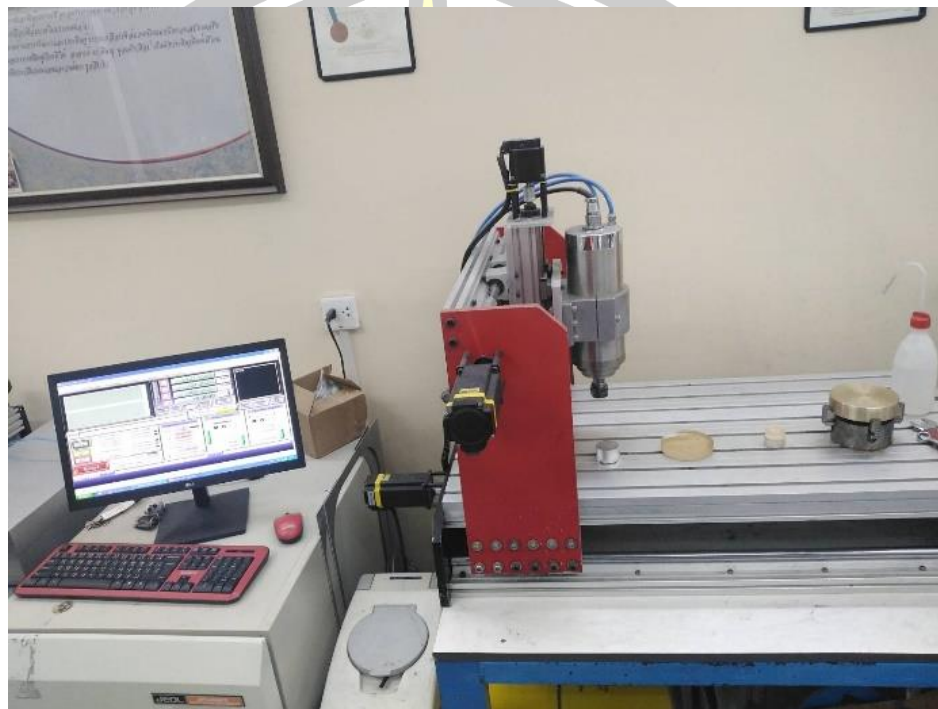
ภาพที่ 3.6 เครื่องกัดซีเอ็นซีที่สร้างขึ้นเอง
