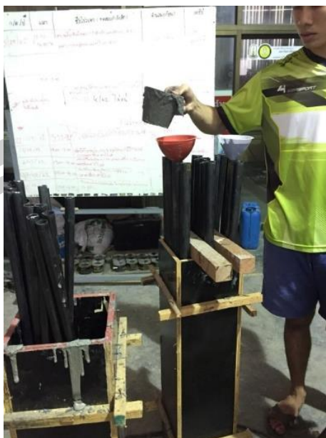
ภาพประกอบ 20 การเทคอนกรีตสมรรถนะสูงพิเศษลงในท่อขนาดต่างๆ
