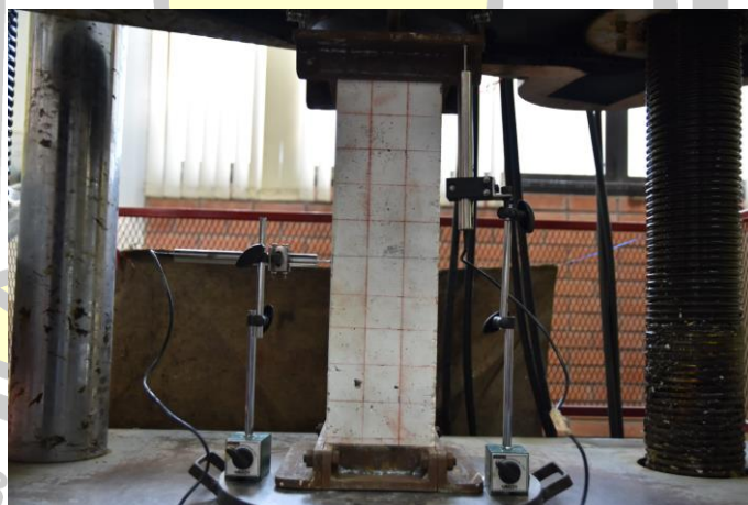
ภาพประกอบ 24 การทดสอบเสาคอนกรีต
