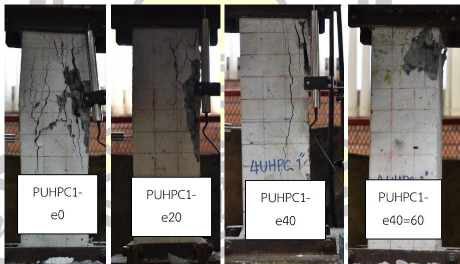
ภาพประกอบ 53 ภาพการวิบัติของเสาคอนกรีตเสริมท่อเหล็กสำเร็จรูปบรรจุ UHPC ขนาด 1 นิ้ว (PUHPC1) ในแนวแกนและที่ระยะเยื้องศูนย์กลางต่างๆ
