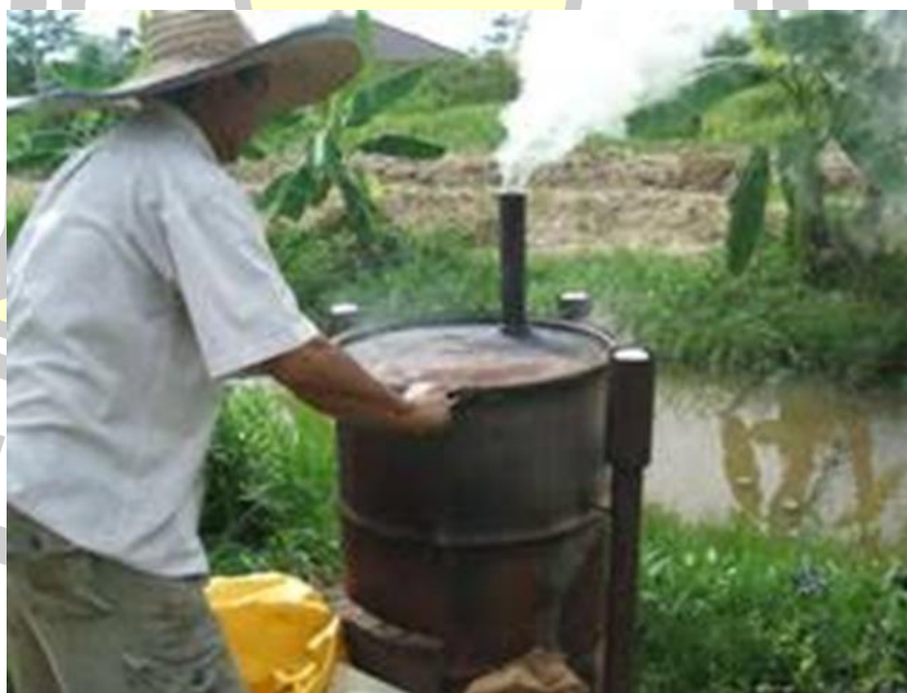
ภาพที่ 18 การเผาถ่านด้วยถัง 200 ลิตร แบบสมัยใหม่
