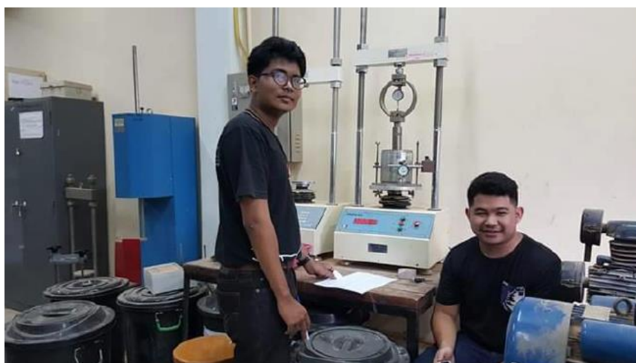
ภาพประกอบ 2.11 การทดสอบ California Bearing Ratio and Swelling test ในห้องปฏิบัติการ
