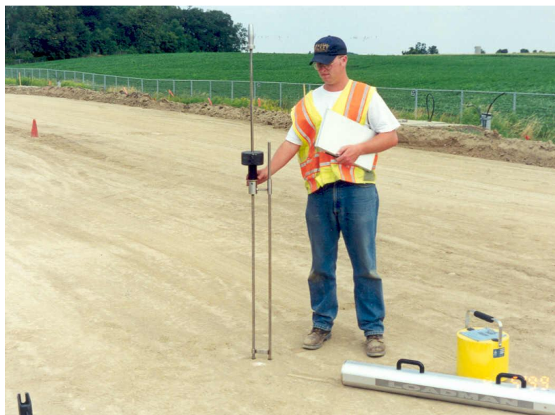
ภาพประกอบ 2.22 การทดสอบ Dynamic Cone Penetration Test ที่มา ( https://pavementinteractive.org )
