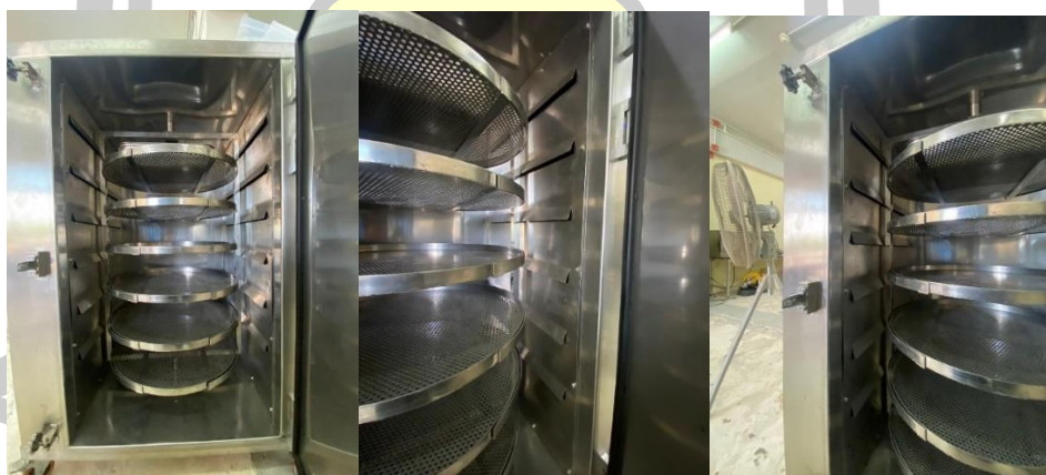
ลักษณะภายในเครื่องอบแห้งลมร้อนแบบถาดหมุน
