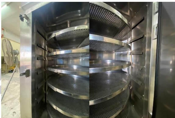
ภาพที่ 36 ช่องลมทั้งสองด้านของห้องอบ จำนวนทั้งสิ้น 12 ช่อง
