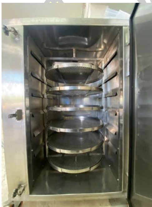
ภาพที่ 38 ส่วนห้องอบและถาดอบแห้งแบบวงกลม
