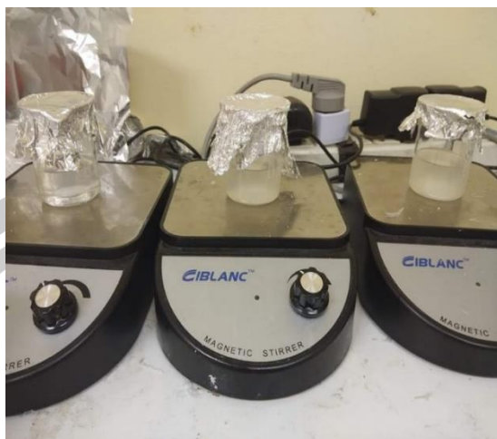
ภาพประกอบที่ 6 ทำการละลายเม็ดพลาสติกด้วยเครื่องกวนสารละลาย
