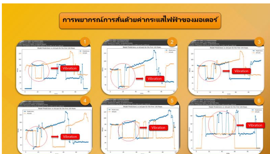
ภาพประกอบ 21 กรณีเกิดการสั่นจากค่ากระแสไฟฟ้าของมอเตอร์
