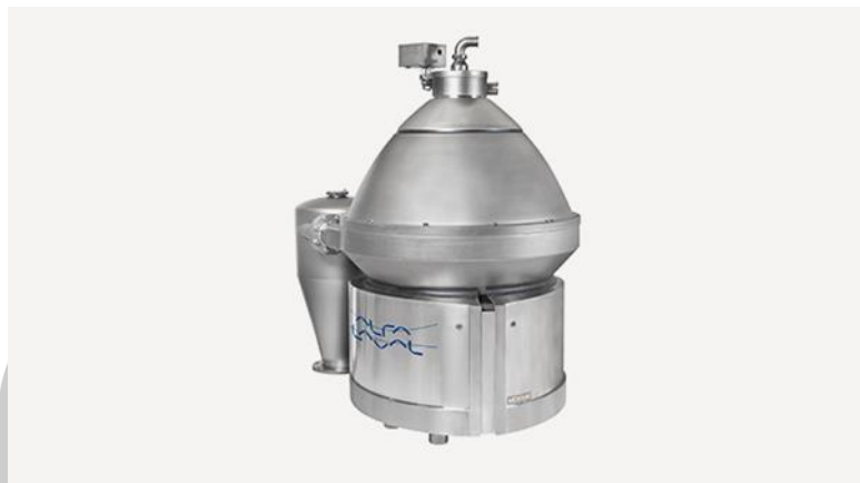
ภาพประกอบ 8 เครื่องหมุนเหวี่ยงแบบจาน[4]
