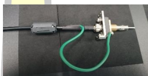
ภาพประกอบที่ 34 สาย BNC RG59 75 โอห์ม การลดสัญญาณรบกวนวิธีการที่ 4
