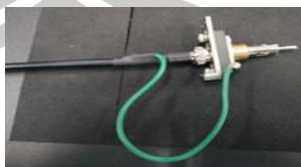
ภาพประกอบที่ 33 สาย BNC RG59 75 โอห์ม การลดสัญญาณรบกวนวิธีการที่ 3
