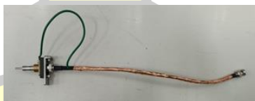
ภาพประกอบที่ 35 สาย BNC RG59 75 โอห์ม การลดสัญญาณรบกวนวิธีการที่ 5
