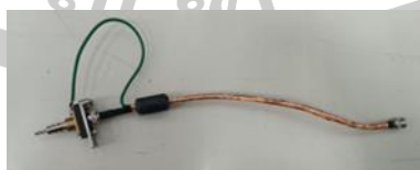
ภาพประกอบที่ 36 สาย BNC RG59 75 โอห์ม การลดสัญญาณรบกวนวิธีการที่ 6
