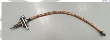
ภาพประกอบที่ 32 สาย BNC RG59 75 โอห์ม การลดสัญญาณรบกวนวิธีที่ 2
