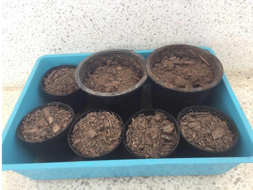
ภาพประกอบ 12 การทดสอบการย่อยสลายโดยการฝังกลบในดิน
