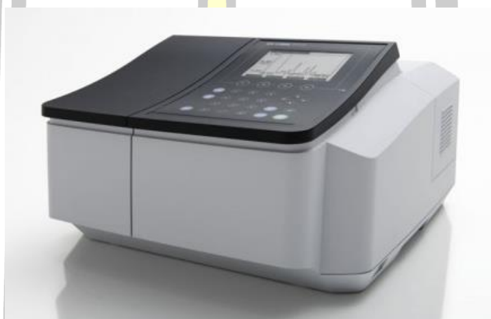
ภาพประกอบ 7 เครื่อง UV-Vis Spectrophotometer รุ่น UV-1800 [31]
