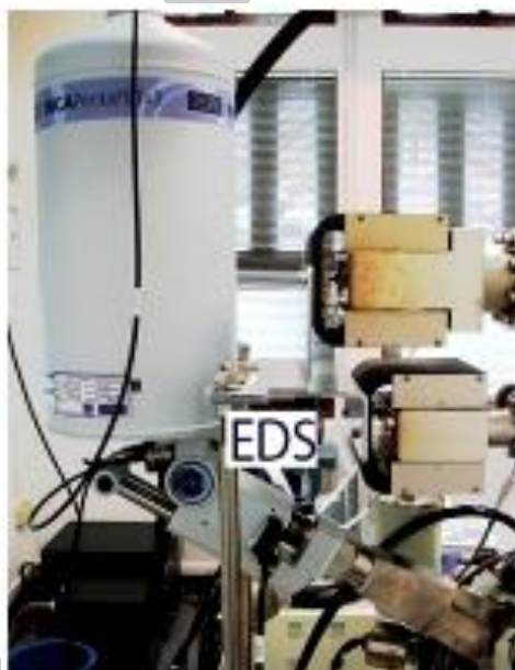
ภาพประกอบ ข.7 เครื่องวิเคราะห์ธาตุด้วยการเรืองแสงรังสีเอ็กซ์แบบ EDS ที่มา: Field Emission Scanning Electron Microscope JSM-7001F, 2014
