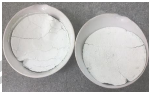
ภาพประกอบ ก.5 การเตรียมตัวเร่งปฏิกิริยา MoHZSM-5 และตัวเร่งปฏิกิริยา Mo/NaZSM-5
