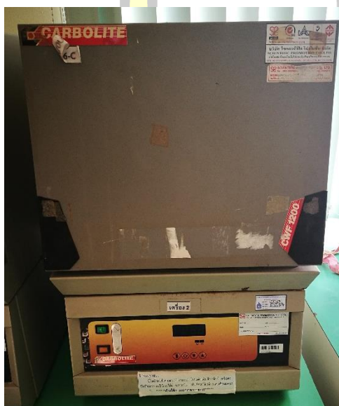
ภาพประกอบ ก.6 เตาเผาอุณหภูมิสูง Muffle Furnaces Carbolite model.CWF 12/13 สำหรับเผาตัวเร่งปฏิกิริยา
