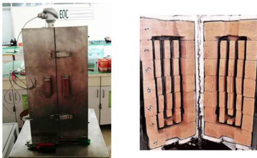
ภาพประกอบ 19 เตาปฏิกรณ์แบบท่อที่ใช้ในการทดลอง
