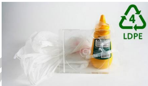
ภาพประกอบ 3 ตัวอย่างผลิตภัณฑ์ของ Low density polyethylene (LDPE) ที่มา: Low density polyethylene (LDPE) / พอลิเอทิลีนความหนาแน่นต่ำ (พิมพ์เพ็ญ พรเฉลิมพงศ์ และ นิธิยา รัตนาปนนท์, 2556)
