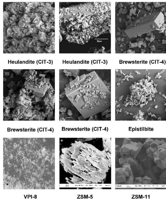
ภาพประกอบ ข.5 ตัวเร่งปฏิกิริยาชนิดต่างๆที่วิเคราะห์ด้วยเครื่อง Scanning Electron Microscope
