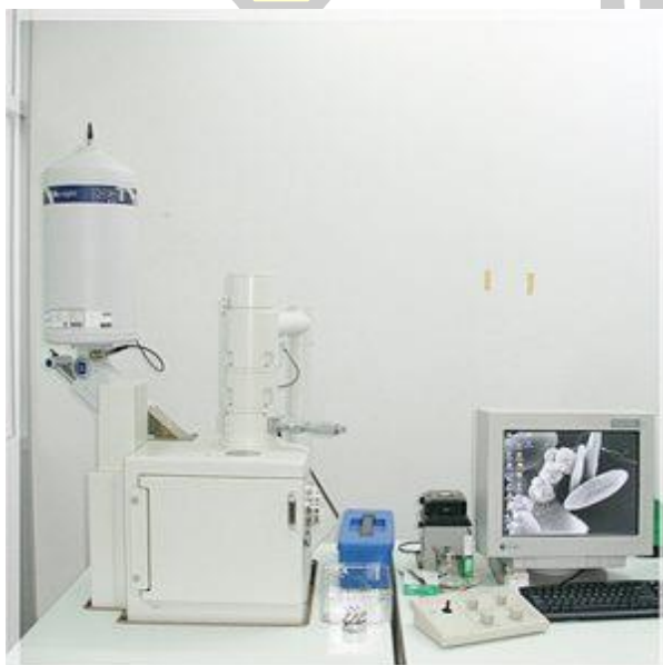
ภาพประกอบ ข.4 เครื่อง Scanning Electron Microscopy (SEM)
