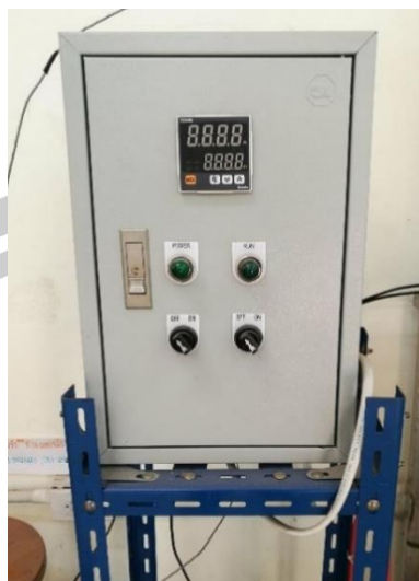
ภาพประกอบ 23 ตู้ควบคุมอุณหภูมิที่ใช้ในการทดลอง
