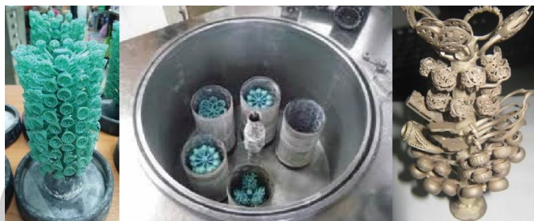
ภาพที่ 88 ต้นแบบ เบ้าเทปูนสำหรับงานหล่อและงานหล่อ
