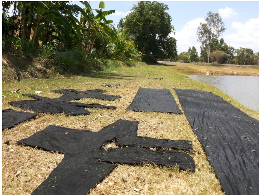
แสดงภาพการตากผ้าที่ผ่านการย้อมแล้วนำมาตากกับสนามหญ้าหรือพื้นดินเพื่อให้สีเสมอกัน
