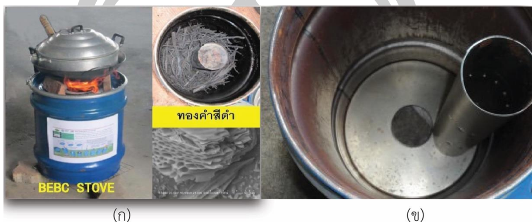
ภาพที่ 9 เตาเบ็บซี ก) ลักษณะการใช้งานและถ่านชีวภาพจากเตา ข) แกนเตาและสภาพภายในเตา (ที่มา: https://www3.rdi.ku.ac.th/?p=20127 )
