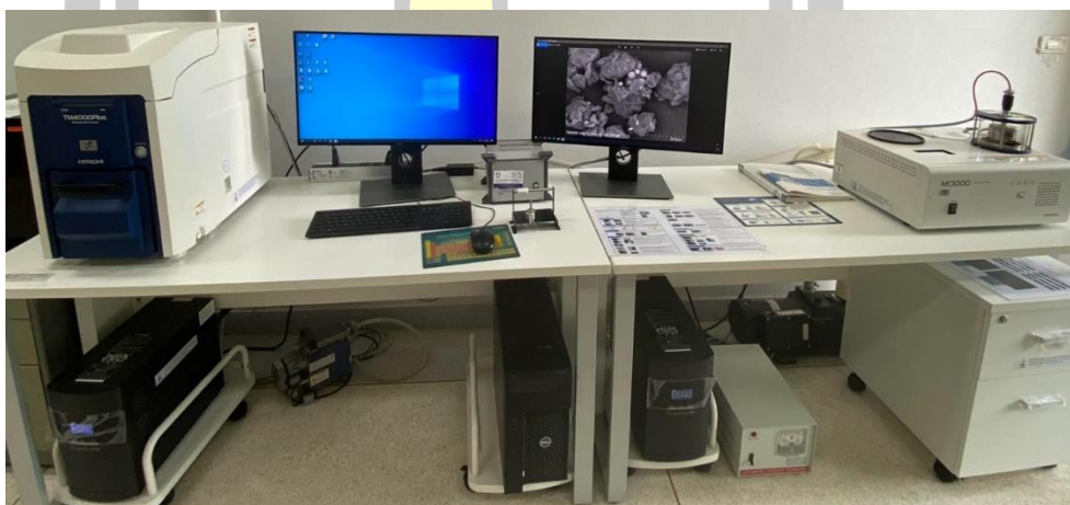
ภาพที่ 19 กล้องจุลทรรศน์อิเล็กตรอนแบบส่องกราด (SEM) และวิเคราะห์องค์ประกอบธาตุ (EDS) (ที่มา: https://res.msu.ac.th/centrallab/ )
