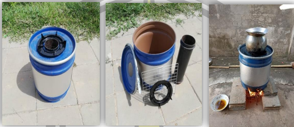
ภาพการออกแบบเตาต้นแบบ และการสร้างเตาต้นแบบ
