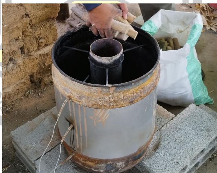
ภาพที่ 15 การวางเตาและติดตั้งเซนเซอร์วัดอุณหภูมิในเตา
