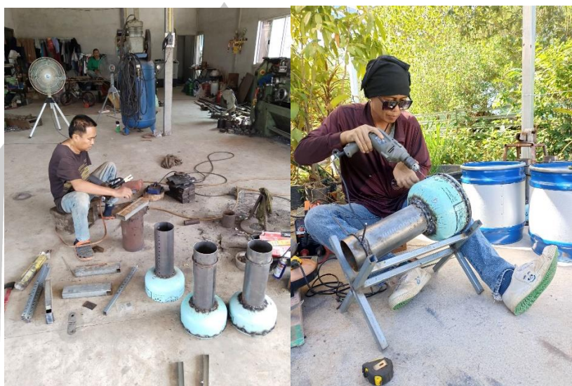
ภาพที่ 12 การสร้างแกนเตาและตัวเตาโดยใช้วัสดุรีไซเคิลจากถังน้ำยาแอร์
