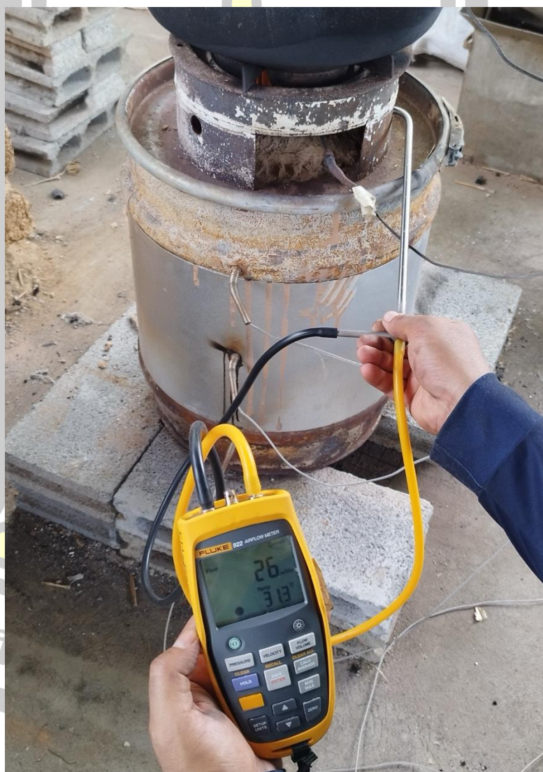
ภาพที่ 16 แสดงการวัดอัตราการไหลของอากาศที่ออกจากแกนเผาไหม้
