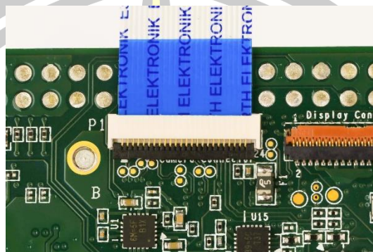
ภาพประกอบ 13 การต่อสายดินเข้ากับ CSI Camera Connector
