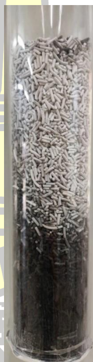
ภาพประกอบ 69 ลักษณะสีของตัวเร่งปฏิกิริยาที่ผ่านการใช้งานและผ่านการฟื้นฟูบางส่วน
