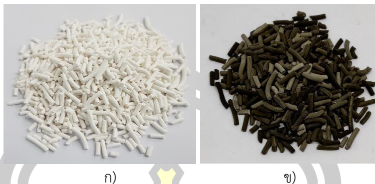
ภาพประกอบ 5 ลักษณะตัวเร่งปฏิกิริยา ZSM-5 ก) ก่อนการใช้งาน และ ข) หลังการใช้งาน
