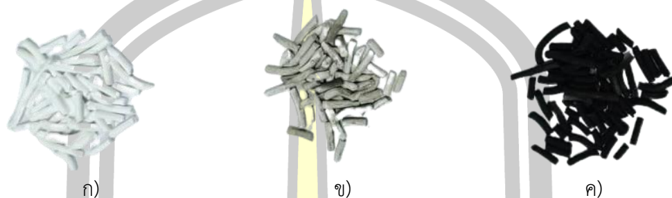
ภาพประกอบ 68 ตัวเร่งปฏิกิริยาที่ผ่านการใช้งานแล้ว แยกเป็นสี ก) ขาว ข) เทา และค) ดำ
