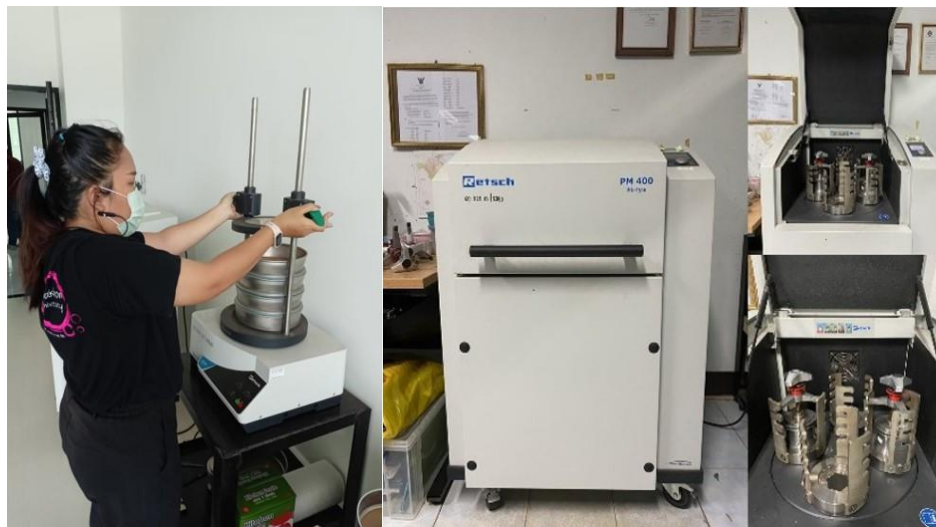
ภาพประกอบ 51 การบดละเอียดแบบปั่นแห้งและการคัดแยกขนาดฝุ่น
