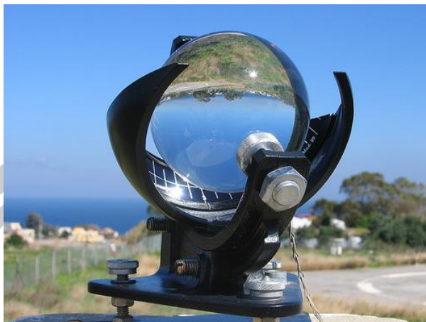
ภาพประกอบ 9 เครื่องวัดแสงแดดแบบแคมป์เบลล์-สโตกส์ [25]
