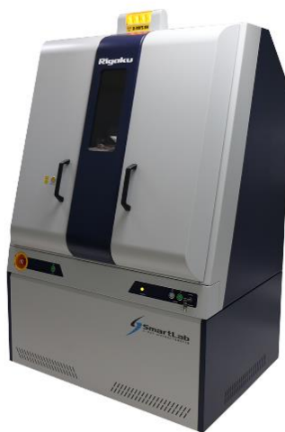
ภาพประกอบ 20 เครื่องวิเคราะห์การเลี้ยวเบนของรังสีเอ็กซ์ X-Ray Diffractometer (XRD) ที่มา : สถาบันวิจัยแสงซินโครตรอน (องค์การมหาชน) กระทรวงวิทยาศาสตร์และเทคโนโลยี (67)
