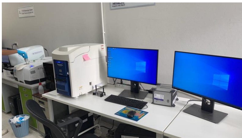
ภาพประกอบ 19 กล้องจุลทรรศน์อิเล็กตรอนแบบส่องกราดและวิเคราะห์องค์ประกอบของธาตุ
