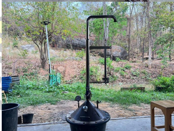
ภาพประกอบ ค2 เตาที่ใช้เผาด้วยกระบวนการไพโรไลซิส
