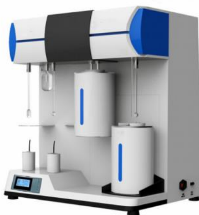
ภาพประกอบ 22 เครื่องวัดพื้นที่ผิวและความเป็นรูพรุนของตัวอย่าง Surface area and porosity analyzer (BET)
