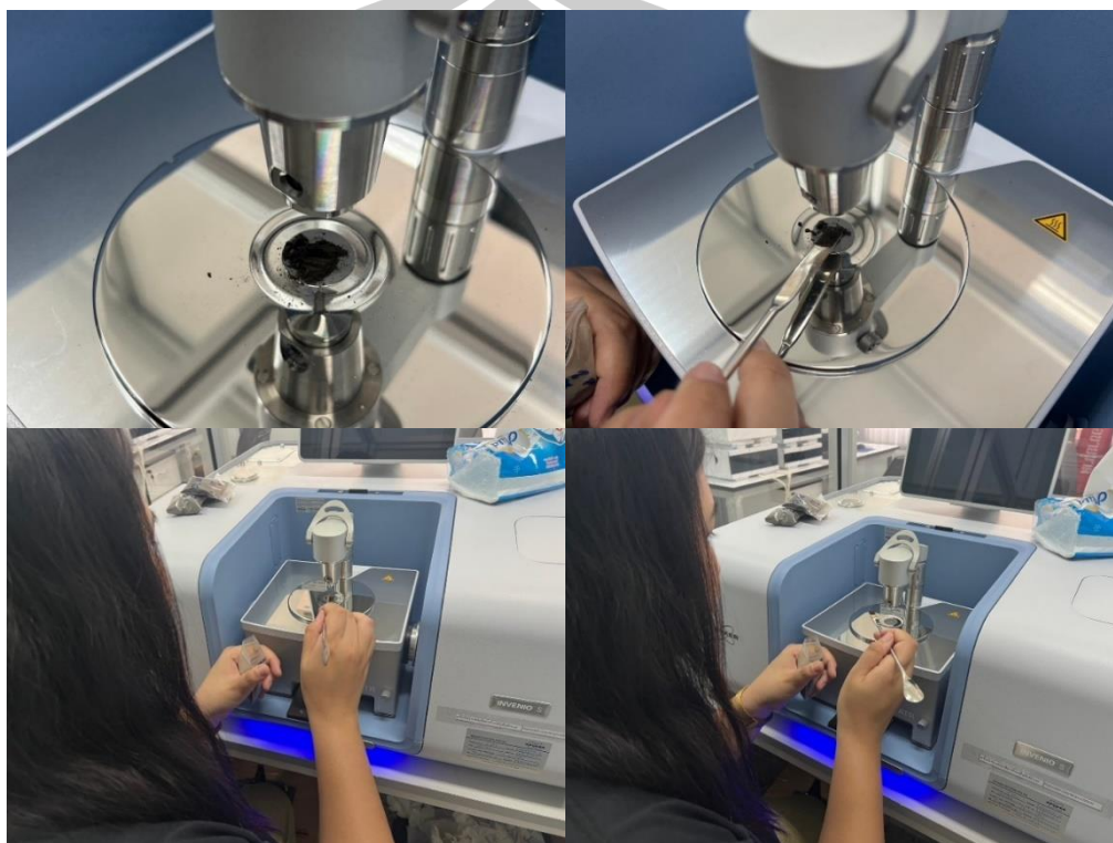
ภาพประกอบ ค18 นำถ่านใส่ลงในเครื่องวิเคราะห์ FTIR
