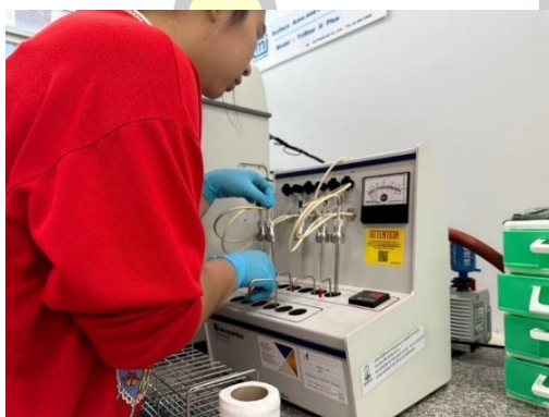
ภาพประกอบ ค24 นำถ่านใส่เครื่องตรวจเช็คความพร้อมก่อนวิเคราะห์
