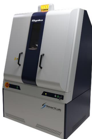
ภาพประกอบ 14 เครื่องวิเคราะห์การเลี้ยวเบนของรังสีเอ็กซ์ X-Ray Diffractometer (XRD) ที่มา : สถาบันวิจัยแสงซินโครตรอน(องค์การมหาชน) กระทรวงวิทยาศาสตร์และเทคโนโลยี [37]
