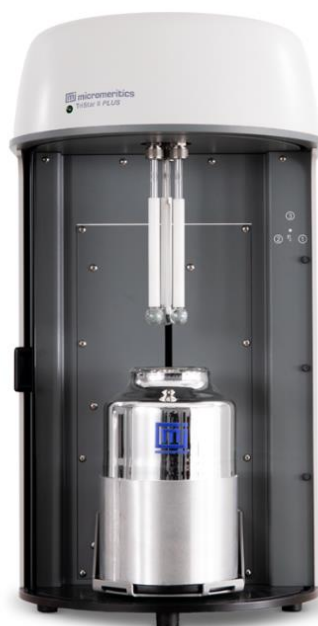
ภาพประกอบ 16 เครื่องวัดพื้นที่ผิวและความเป็นรูพรุนของตัวอย่าง Surface area and porosity analyzer (BET)
