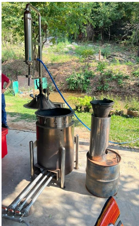
ภาพประกอบ 10 เตาเผาไร้อากาศเผาไหม้แบบสมบูรณ์ (Pyrolysis with Afterburning Process)
