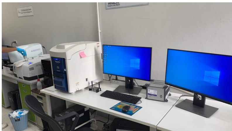
ภาพประกอบ 13 กล้องจุลทรรศน์อิเล็กตรอนแบบส่องกราดและวิเคราะห์องค์ประกอบของธาตุ
