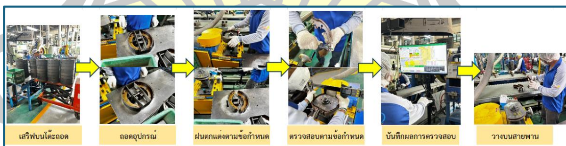
ภาพประกอบ 20 ขั้นตอนการฝนตกแต่งและวัดตรวจสอบก้ามเบรก
