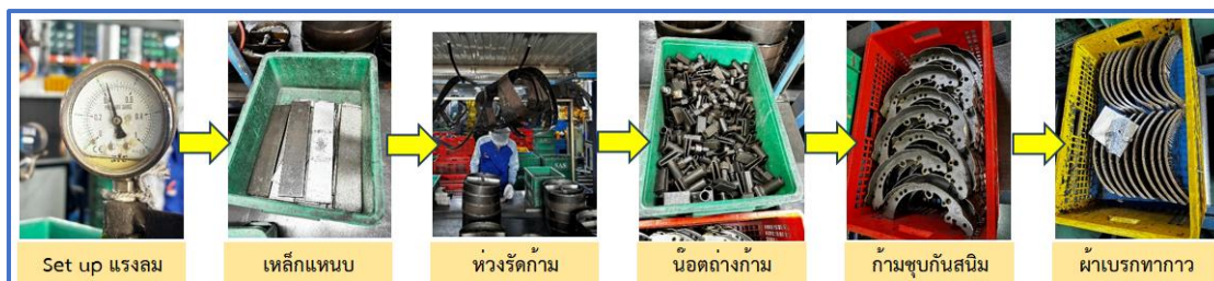
ภาพประกอบ 17 จัดเตรียมอุปกรณ์ประกอบก้ามตามลำดับการผลิต
