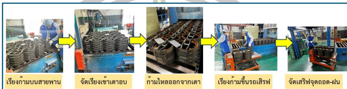
ภาพประกอบ 19 ขั้นตอนการจัดวางก้ามเบรกเข้า-ออกเตาอบ
