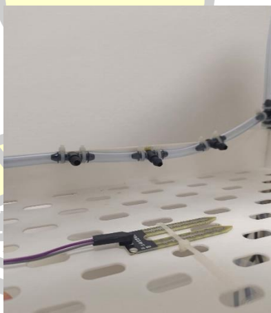
รูปภาพที่ 56 ส่วนของระบบวัดความชื้นในดินและรดน้ำ
