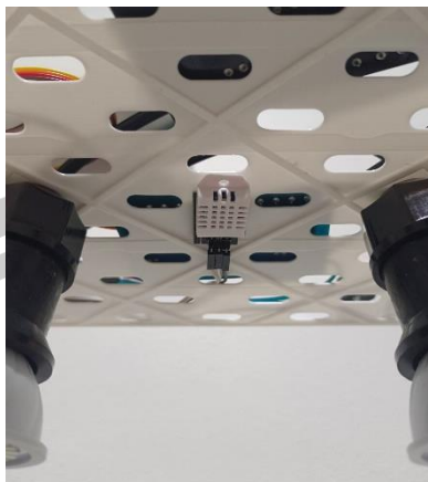
รูปภาพที่ 59 ส่วนของระบบวัดอุณหภูมิอุปกรณ์เพาะปลูก
