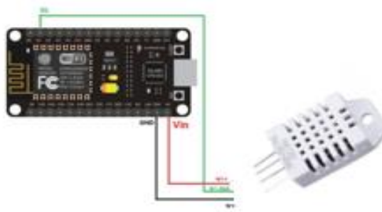
รูปภาพที่ 32 ลักษณะและการเชื่อมต่อของอุปกรณ์ฮาร์ดแวร์ระบบวัดอุณหภูมิอุปกรณ์เพาะปลูก
