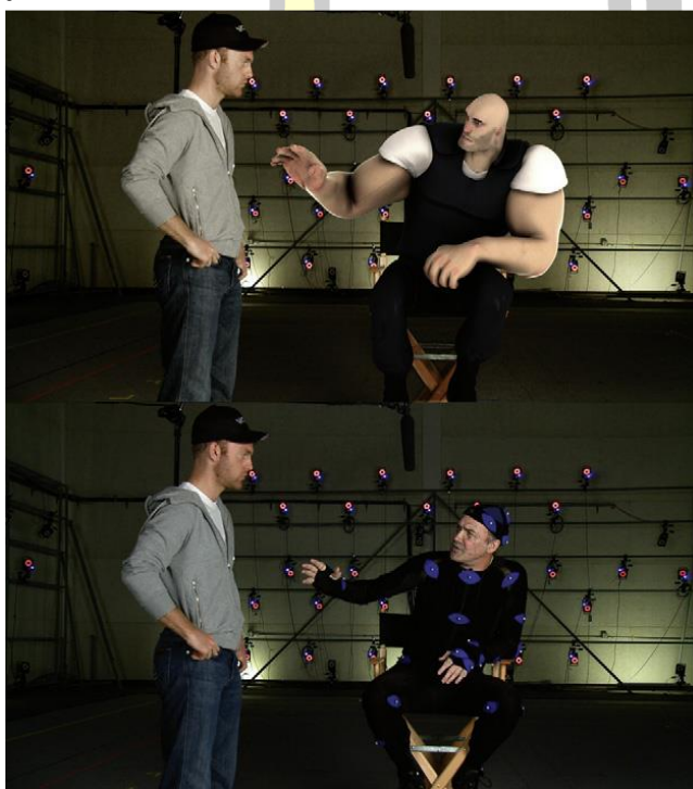
ภาพที่ 1 แบบใช้มาร์คเกอร์เป็นตัวสะท้อนแสง (Passive markers)
