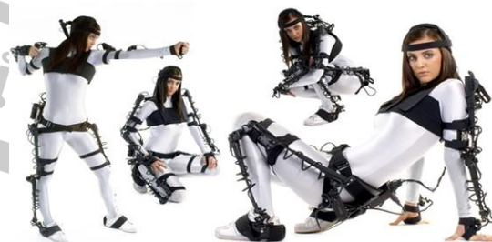
ภาพที่ 5 ระบบจับการเคลื่อนไหวแบบกลไก ( Mechanical motion capture)
