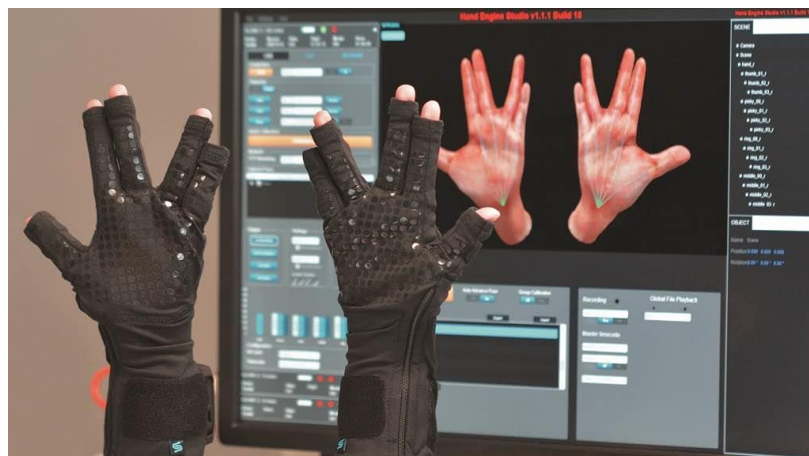
ภาพที่ 7 ระบบเซ็นเซอร์การยืดตัว (Stretch sensors)
