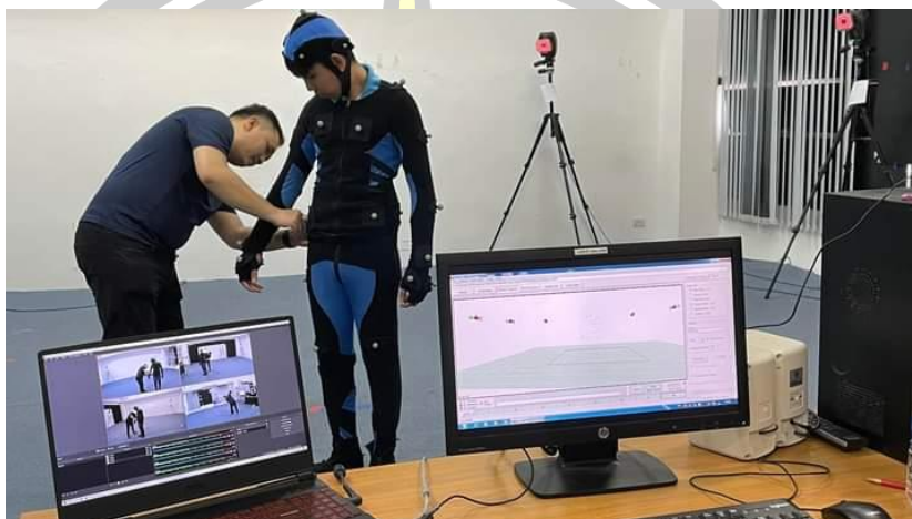
ภาพที่ 79 บันทึกข้อมูลการเคลื่อนไหวของนักแสดงด้วย Optical mocap และ AI mocap
