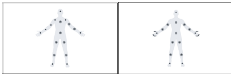
ภาพประกอบที่ 8 การติดจุดเซนเซอร์จำนวน 17 จุด แบบเต็มตัว (Full Body) และจำนวน 31 จุด เมื่อรวมถุงมือข้อมูลทั้งสองข้าง (Noitom, 2022)
