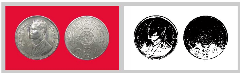
ภาพที่ 12 ภาพขาวดำที่ฟิกเชลต่ำกว่าเทรชโฮลด์ (วัตถุจะมีสีดำและพื้นหลังเป็นสีขาว)
