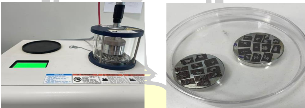
ภาพที่ 27 การเคลือบพื้นผิวตัวอย่างพลาสติกหลักการย่อยสลายทางชีวภาพก่อนนำไปวิเคราะห์ด้วยเครื่อง SEM
