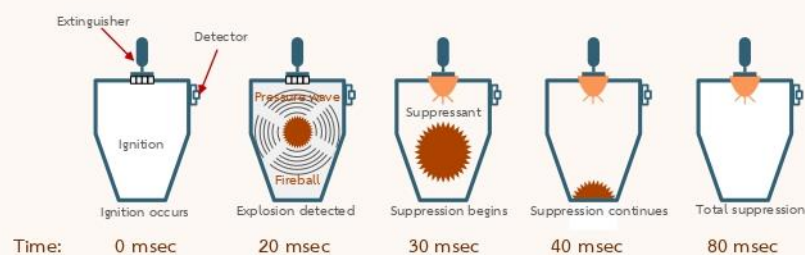
ภาพที่ 11 ตัวอย่าง การตรวจจับและระงับการระเบิดด้วยการแทนที่ด้วย CO 2 ในถังเก็บขนาด 1 m 3
