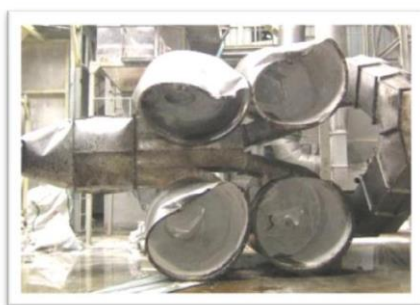
ภาพที่ 6 แสดงผลกระทบจากการระเบิดฝุ่นมันเส้นที่ทำให้ชุดไซโคลน และชุด Hopper ที่มา: กรมโรงงานอุตสาหกรรม (2553)
