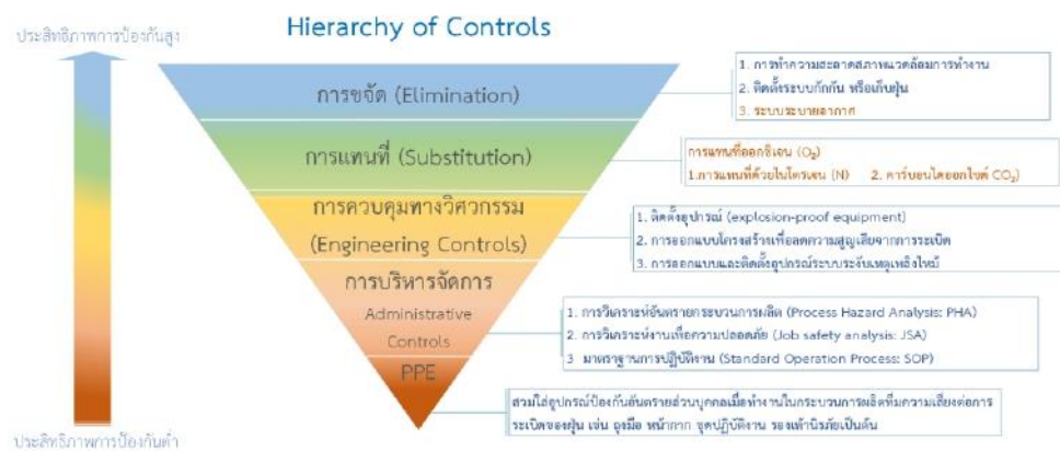
ภาพที่ 8 แนวทางการป้องกันการระเบิดของฝุ่นในกระบวนการจัดเก็บมันเส้นด้วยลำดับชั้นของการควบคุมอันตราย (Hierarchy of controls)
