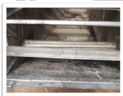
ภาพที่ 7 แสดงผลจากการลุกไหม้ไฟบริเวณไส้กรองอากาศใต้ไซโคลนร้อน ที่มา: กรมโรงงานอุตสาหกรรม (2553)
