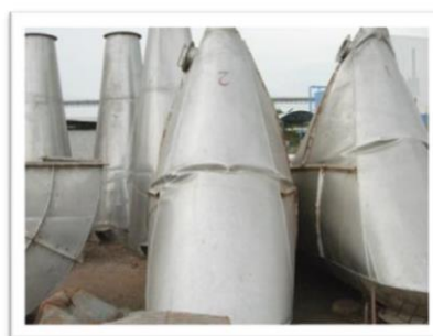
ภาพที่ 6 แสดงผลกระทบจากการระเบิดฝุ่นมันเส้นที่ทำให้ชุดไซโคลน และชุด Hopper ที่มา: กรมโรงงานอุตสาหกรรม (2553)
