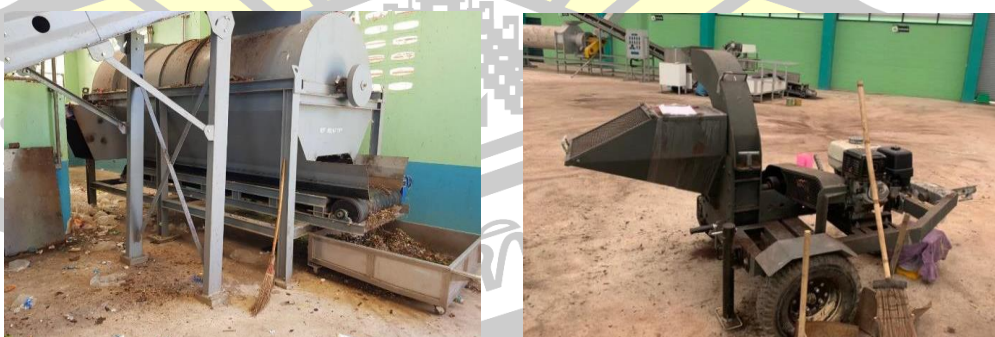
ภาพประกอบ 2 เครื่องลดขนาดมูลฝอยและการใช้ตะแกรงร่อน ที่มา: กรมควบคุมมลพิษ (2565)
