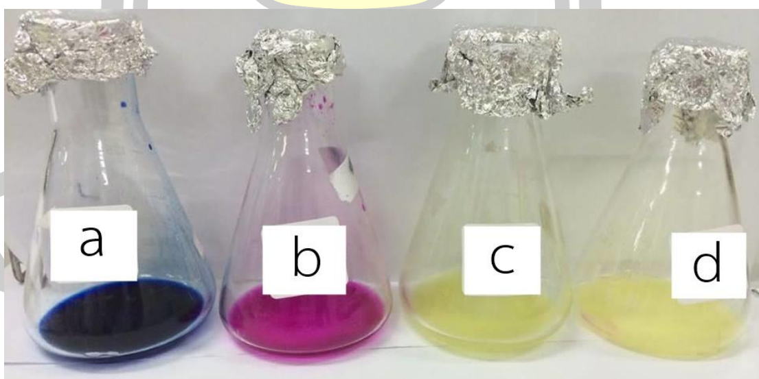
ภาพประกอบ 14 การเทียบสีความแรงเบสของถ้ำซากไก่ด้วยวิธี Hammett indicators method
