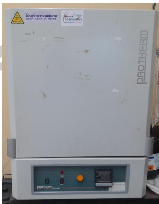
ภาพประกอบ ค.1 เตาอบโลหะ (Protherm PLF 130/15)
