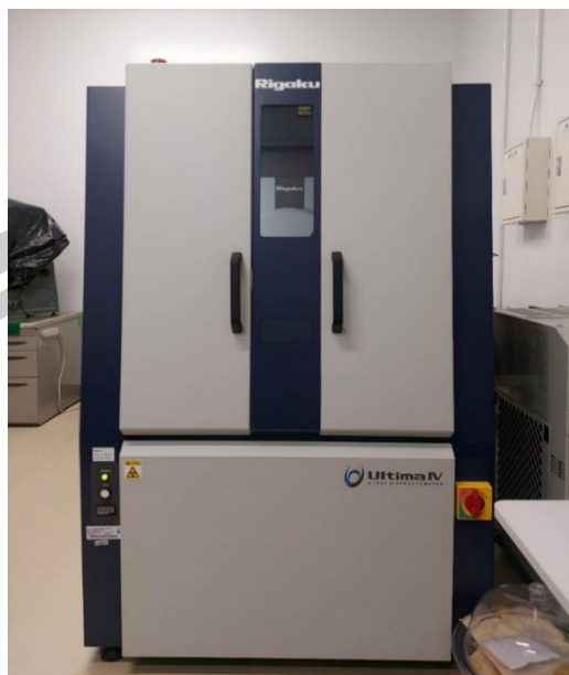
ภาพประกอบ ค.7 เครื่องทดสอบ X-Ray Diffractometer (Rigaku Ultima IV)
