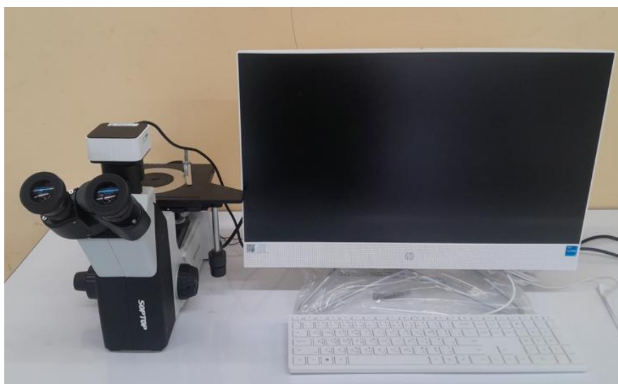
ภาพประกอบ ค.3 กล้องจุลทรรศน์แบบใช้แสง (OM) (Soptop GT-12)
