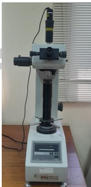
ภาพประกอบ ค.5 เครื่องทดสอบ Macro-Vickers Hardness Tester (LV-100AT) น้ำหนักกด 297N (30 Kgf)
