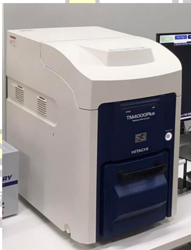
ภาพประกอบ ค.4 กล้องจุลทรรศน์อิเล็กตรอนชนิดส่องกราด (SEM) (TM-4000Plus) (ศูนย์เครื่องมือกลาง มหาวิทยาลัยมหาสารคาม)
