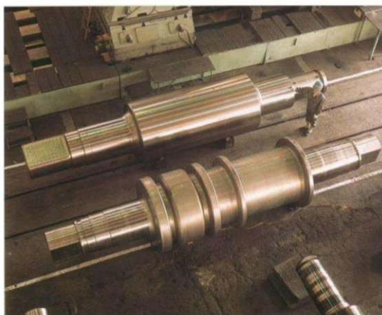
ภาพประกอบ 2 ลูกกรีดสำหรับขึ้นรูปเย็นในอุตสาหกรรมการผลิตเหล็กกล้า [1]
