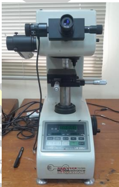
ภาพประกอบ ค.6 เครื่องทดสอบ Micro-Vickers Hardness Tester (LM-300AT) น้ำหนักกด 1N (100 Gf)
