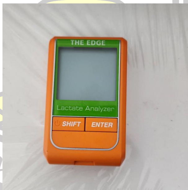
ภาพที่ 23 เครื่องตรวจความเข้มข้นของแลคเตทในเลือด
