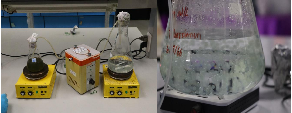
ภาพประกอบที่ 15 การห่อหุ้มสปอร์ของเชื้อรา T. harzianum โดยใช้สปอร์แขวนลอยค้ของเชื้อรา ผสมกับโซเดียมอัลจิเนตหยดลงในสารละลายแคลเซียมคลอไรด์ไดไฮเดรต ( \text{CaCl}_2 \cdot 2\text{H}_2\text{O} ) ด้วยปั้มดูดจ่ายของเหลวแบบรีดท้อ (peristaltic pump)
